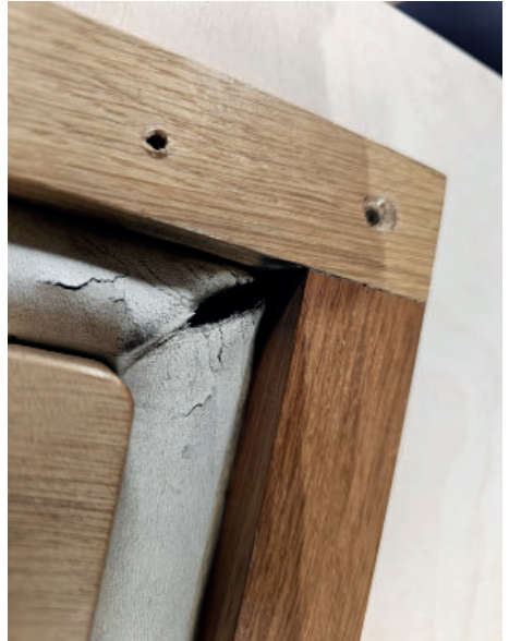
Diese poröse Schadstelle am Blasebalg musste repariert werden.
